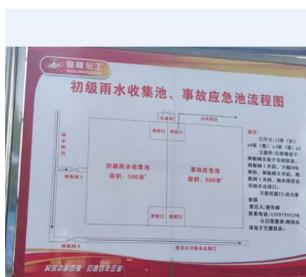
初期雨水池、事故水池
